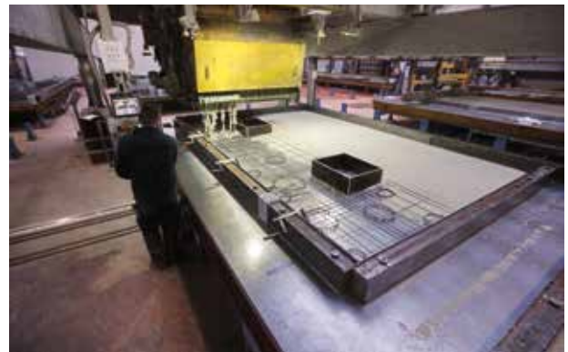
De wapening van de binnenwand plaatsen.
