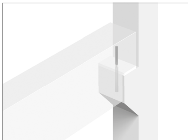
Afb. 16: Schöck Dorn: Vastzetting van een balk op een console
