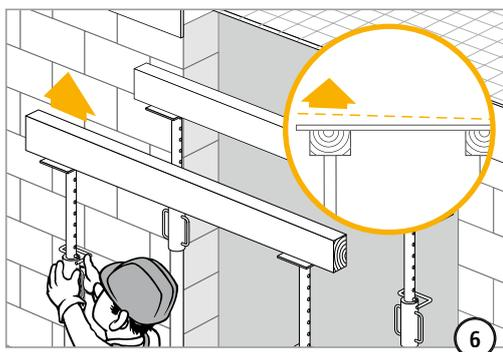
Surélever l'élément conformément au plan d'exécution.
