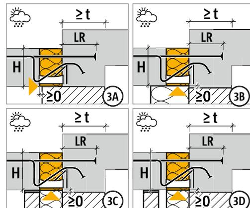
3A: Poser le bord extérieur de l'Isokorb® directement devant le bord extérieur du mur. 3B-3D: Placer le bord extérieur de l'Isokorb® directement contre ou au-dessus du bord extérieur de la poutre
