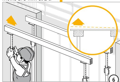
Surélever l'élément conformément au plan d'exécution.
