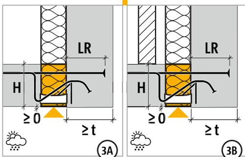
Mettre le bord inférieur de l'Isokorb® au même niveau ou au-dessus du bord inférieur du mur.
