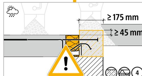
Dans la zone marquée, n'effectuer aucun joint de construction horizontal ou vertical. Bétonner la zone marquée en un seul bloc !
