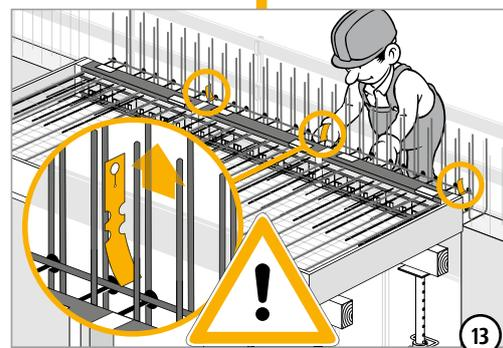
Avant le bétonnage, retirer toutes les étiquettes de mise en garde !
