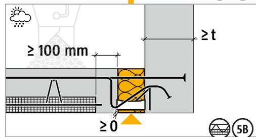
Remplir impérativement l'élément de compression avec du béton coulé sur place !
