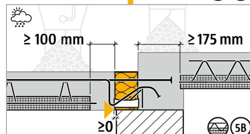
Remplir impérativement l'élément de compression avec du béton coulé sur place ! Largeur du joint ≥ 100 mm. Largeur de la poutre d'au moins 175 mm.
