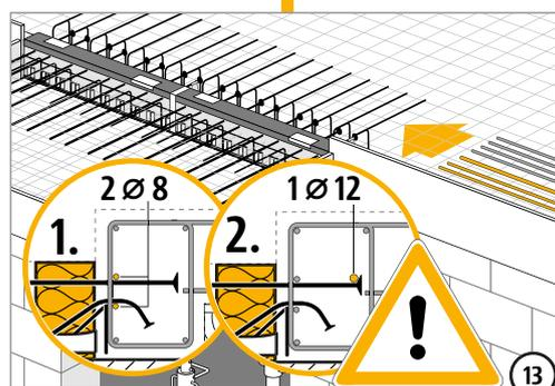
Attacher les barres de compression de  $\varnothing \geq 8$  mm au niveau des points de jonction. Attacher la barre de traction de  $\varnothing \geq 12$  mm directement sur la barre de traction au moyen d'une tête d'ancrage !
