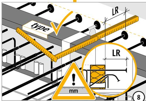
Vérifier la longueur d'ancrage LR sur l'étiquette des caractéristiques !
